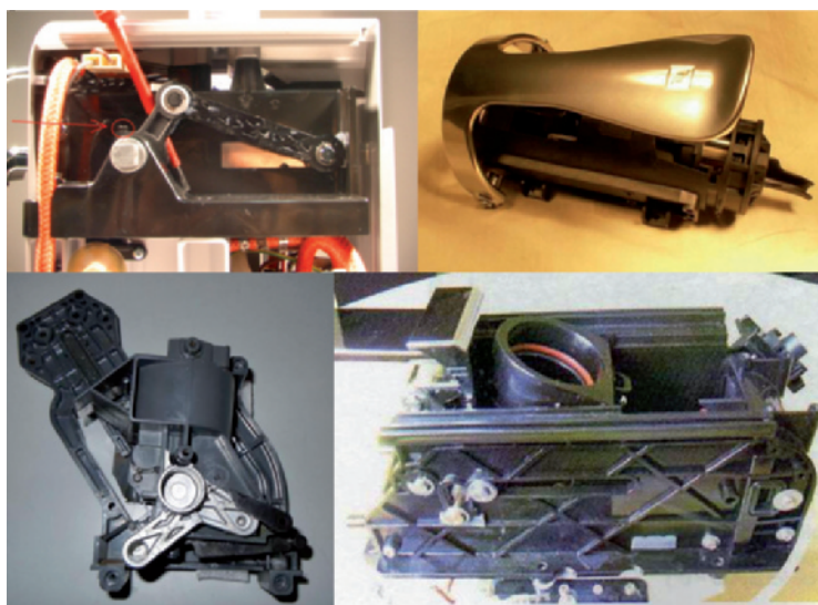
Fig. 2 – Alcuni cinematismi traslativi (in alto) e roto-traslativi (in basso)
